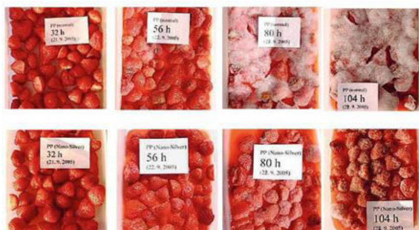
Εικόνα 1 Φράουλες σε συμβατική συσκευασία (πάνω γραμμή) και σε νανοσυσκευασία αργύρου (κάτω γραμμή).
